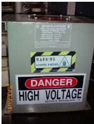
Working voltage : 10kV /20kV /30kV /40kV DC
